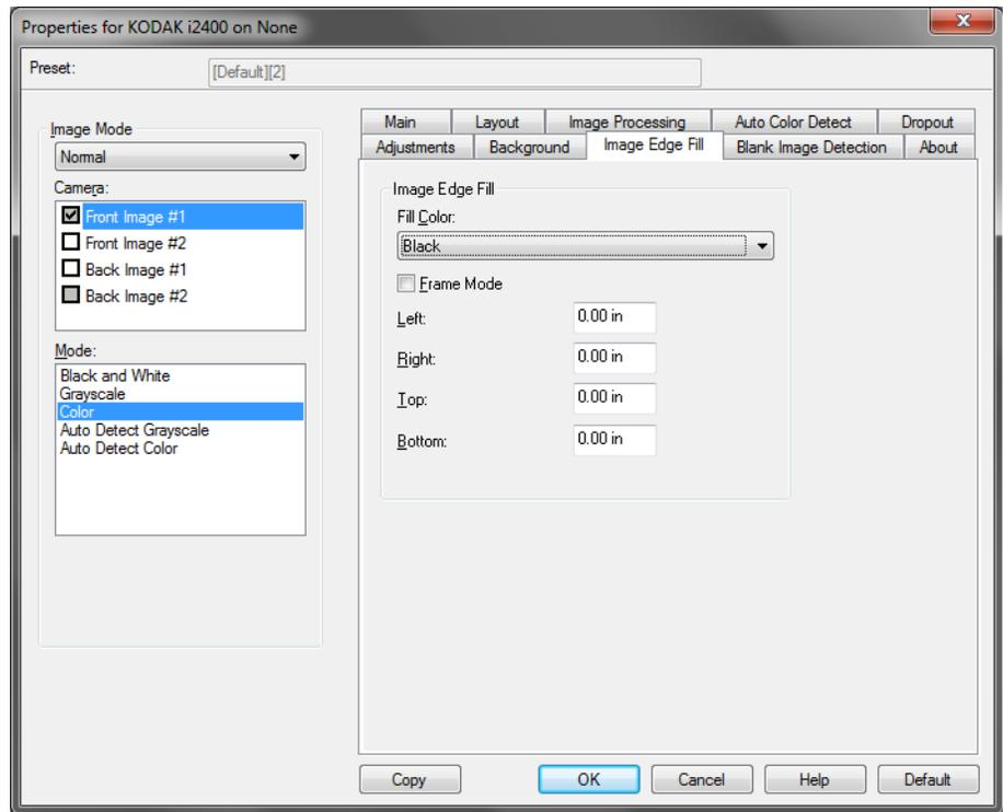
**影像边缘填充** — 用黑或白覆盖该区域来填满最终电子影像的边缘。“填满影像边缘”会在应用所有的其他影像处理选项后执行。
