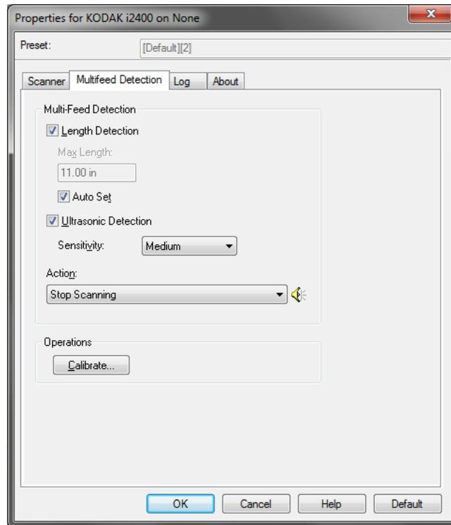
**长度检测** — 可启用或禁用此选项。默认值为禁用。如果启用，请选择在没有检测到重张进纸时，可以扫描的文档最大长度。长度检测最适合在扫描相同尺寸的文档时用以检查是否出现重叠。例如，如果以纵向模式扫描 8.5 x 11 英寸 (A4) 文档，请在 **最大长度** 字段中输入值 28.57 厘米 (11.25 英寸)。最大值为 35.56 厘米 (13.99 英寸)。
