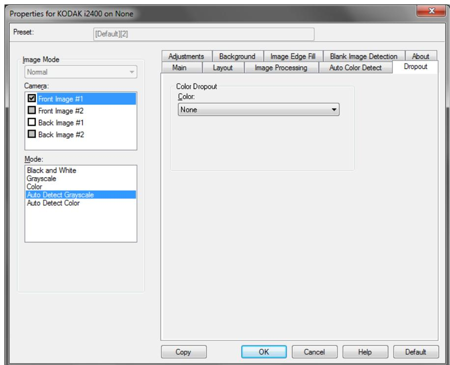
“滤色”选项卡用于消除表格的背景，使电子影像中只包含输入的数据（即清除表格的线和框）。对于黑白影像，这些设置会影响扫描仪分析用来制作电子影像的文档灰度版本的方式。
