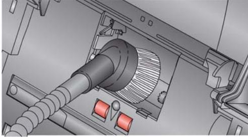
6. Reinserire il modulo di alimentazione allineando i perni e spingendolo verso sinistra per riposizionarlo. Verificare che gli ingranaggi siano allineati e che il modulo scatti in posizione. Reinserire il modulo di alimentazione in posizione.
