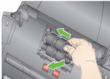
3. Ruotare manualmente e pulire le gomme del modulo di alimentazione con un tampone di pulizia per i rulli.
