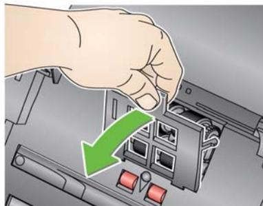
2. Ruotare il modulo di alimentazione in avanti e spingerlo a sinistra per estrarlo.
