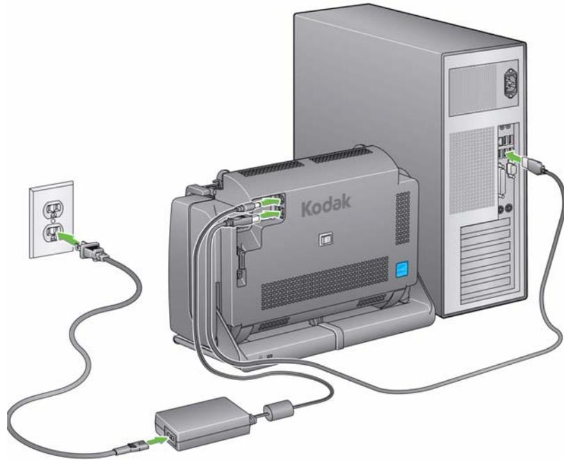
NOTA Il LED verde dell'alimentatore indica che il dispositivo è attivato.
