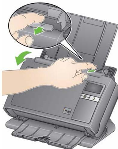
3. Dopo aver pulito lo scanner o sostituito un componente, chiudere il coperchio dello scanner con entrambe le mani.
