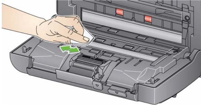
2. Pulire nuovamente l'area di imaging superiore e inferiore utilizzando un panno Brillianize (passaggio 2) o un panno antistatico non completamente asciutto per rimuovere eventuali striature.
