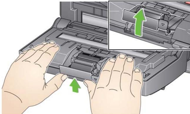
2. Ruotare manualmente e pulire le gomme del modulo separatore con un tampone di pulizia per i rulli.
