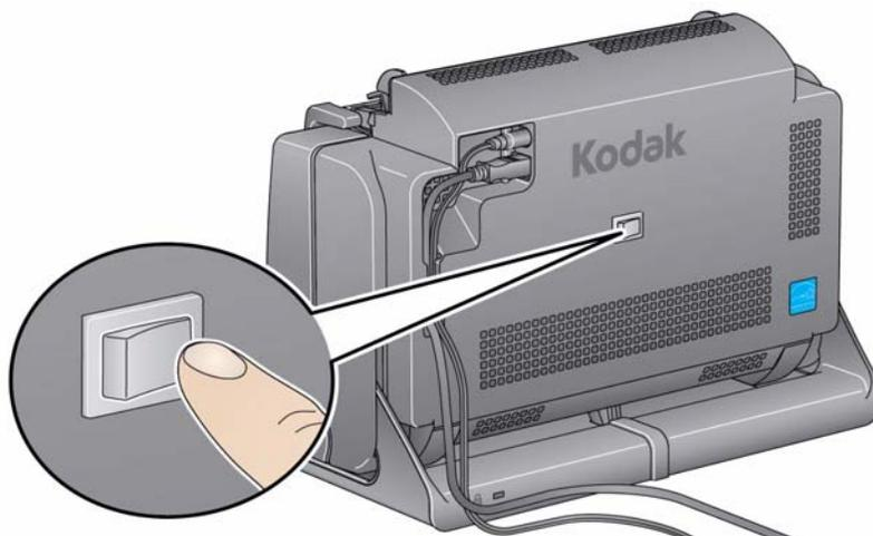
Una volta attivato lo scanner, il pulsante LED/di avvio nella parte superiore dello scanner lampeggerà mentre lo scanner eseguirà una serie di auto-test.
