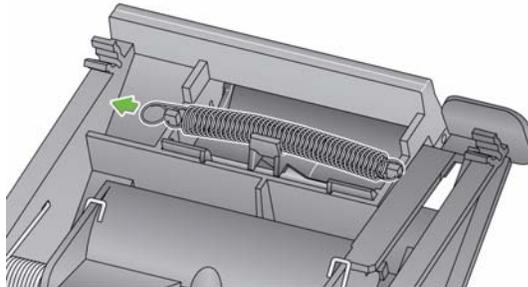
4. Al termine, reinstallare il modulo separatore facendo attenzione ad allineare le linguette e facendo scattare in posizione il modulo stesso.
