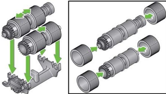
7. Reinstallare il modulo di alimentazione.
